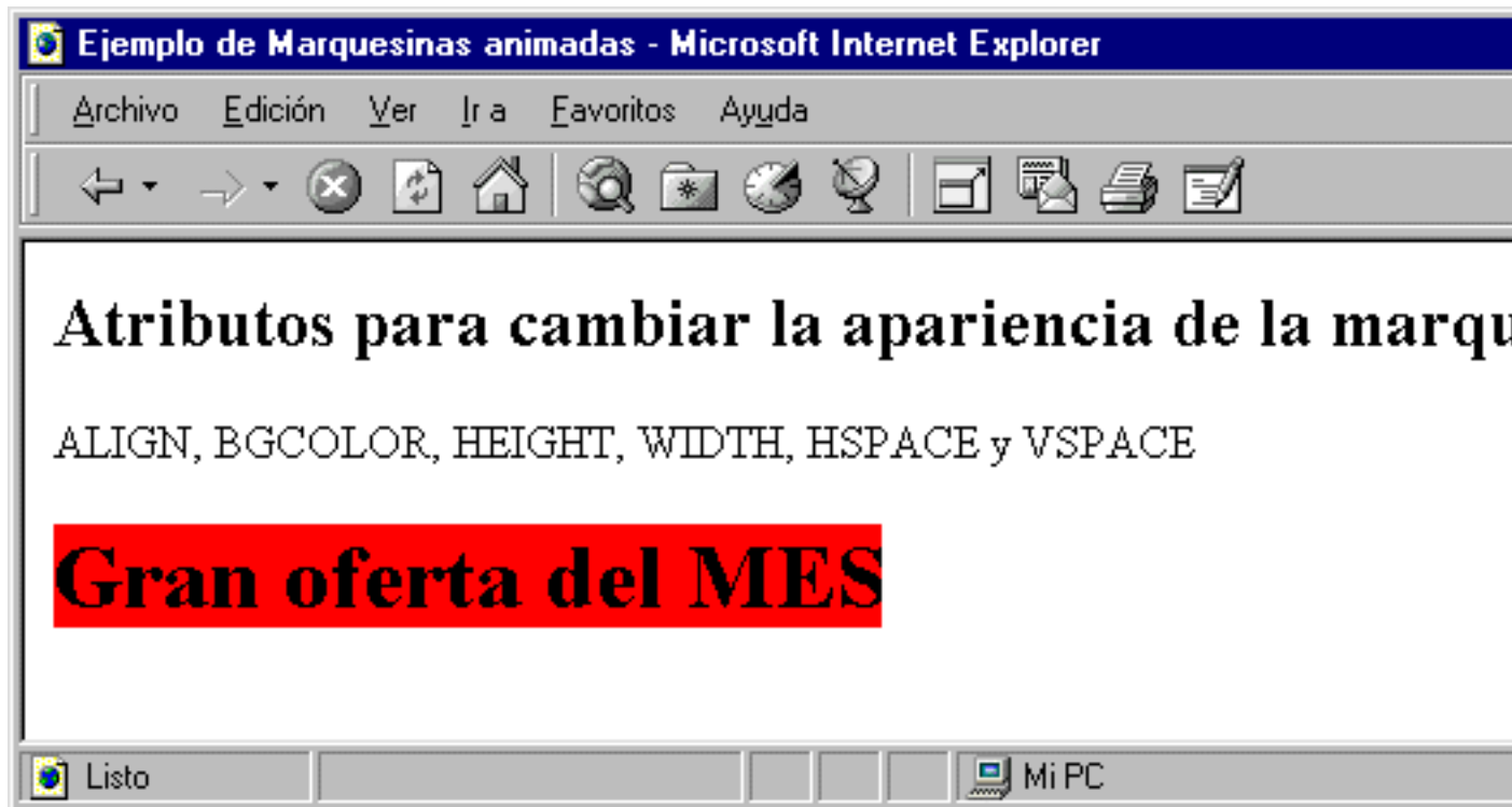
Figura 10.9. La etiqueta MARQUEE está acompañada de numerosos atributos que nos permiten controlar la apariencia de la marquesina.
