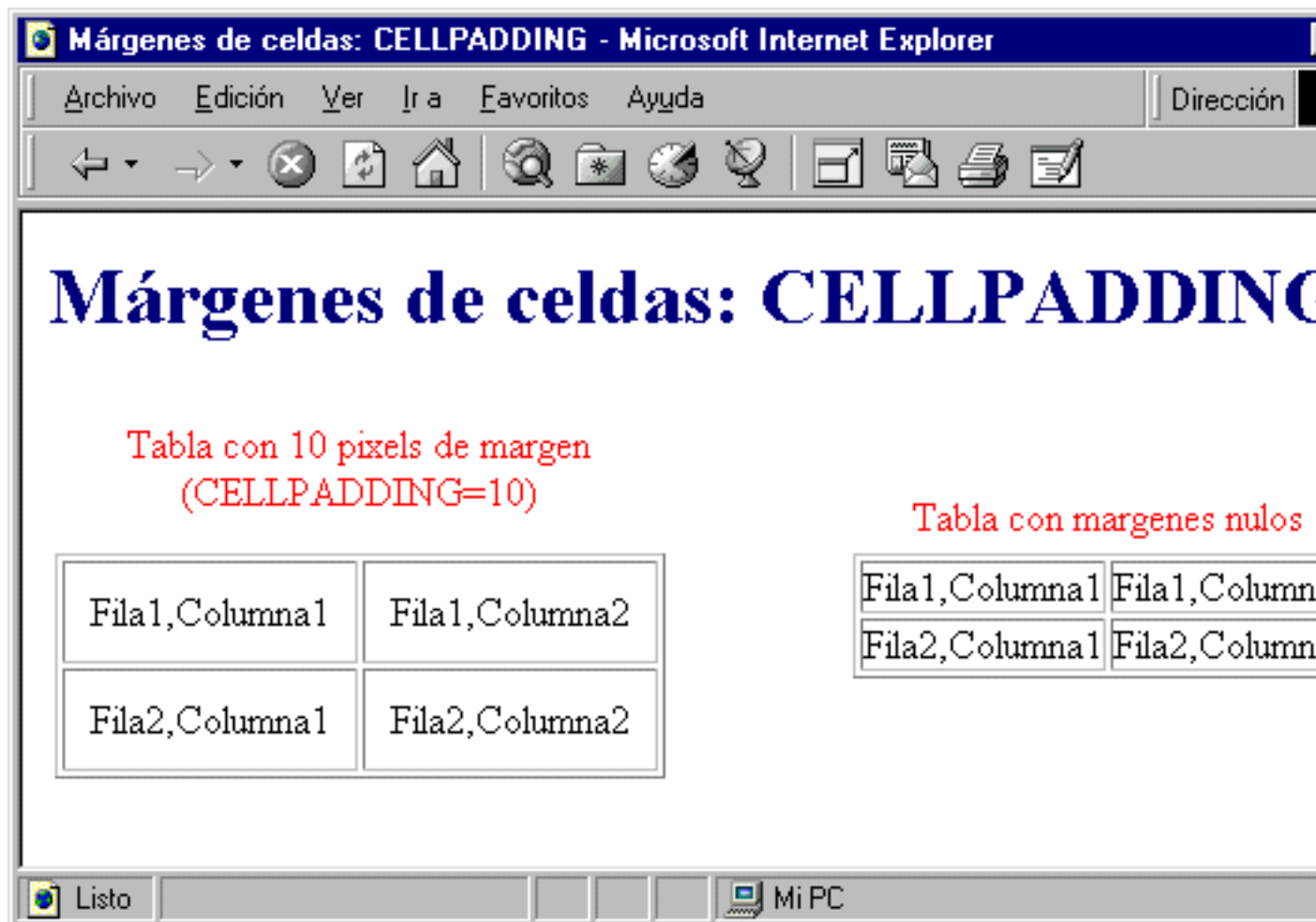
Figura 7.17. Con el atributo CELLPADDING podemos aumentar los márgenes entre el contenido de las celdas y su borde.
