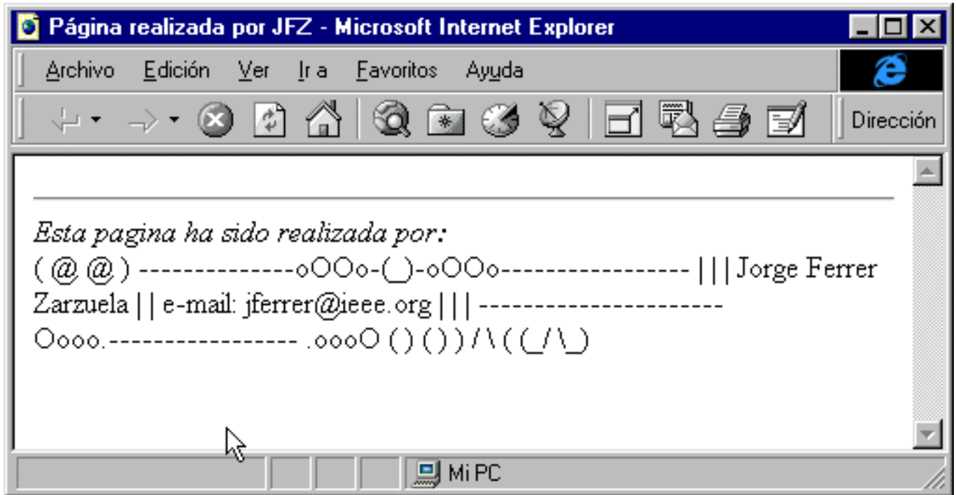
Figura 3.11. Si no usamos la etiqueta de texto preformateado la figura construida con caracteres se convertirá en algo ilegible.
